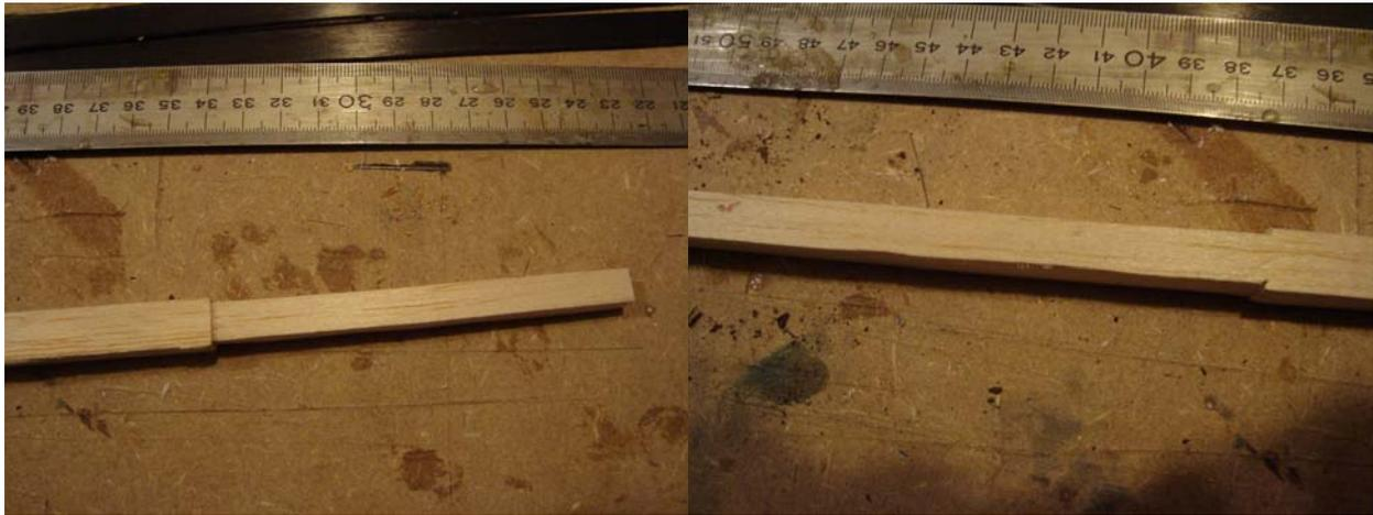
*Réalisation des embrèvements pour les fourreaux de clé (à gauche) et le doublement de l'épaisseur de semelle (à droite). Etre précis dans les cotes.*
