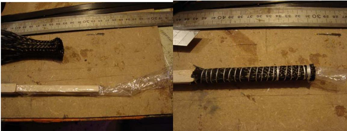
*Pose du film alimentaire de protection et de la gaine carbone du fourreau. Le fil permet de bien immobiliser l'ensemble et apporte un peu de solidité à l'éclatement.*
